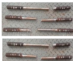
Gambar 9. Hasil pengujian kekuatan tarik hardfacing welding arus 120 A.
