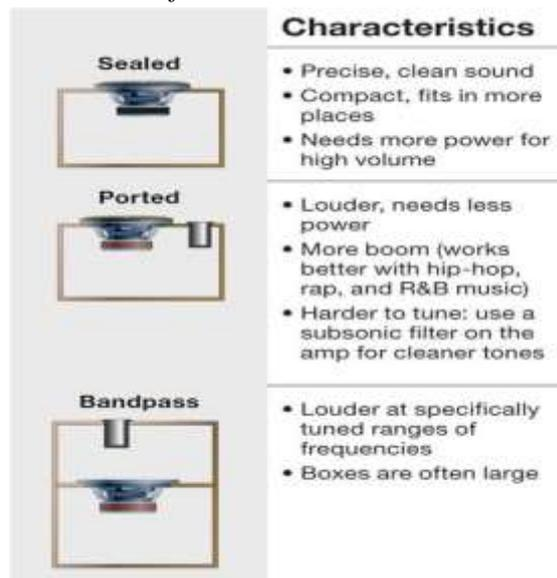
Gambar 12. Jenis Kotak Loudspeaker <sup>9</sup>
