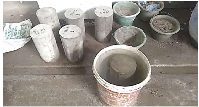
Gambar 9. Perendaman Beton Dengan Limbah Biji Salak
