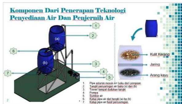
**Gambar 1.** Konstruksi dan alat penyediaan air dan penjernih air.
