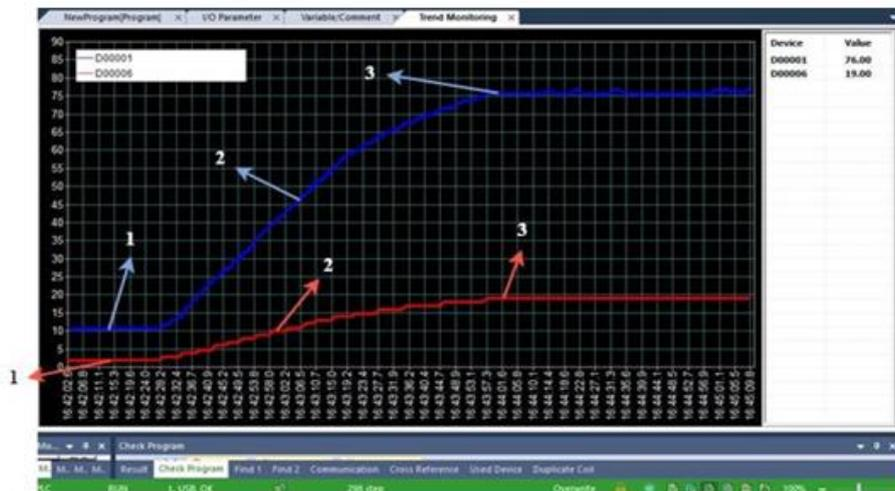
Gambar 10. Grafik Level Air dan Tegangan Pompa Aktif
