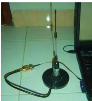
Gambar 5 Koneksi antara Antena Luar, Pigtail dan PCMCIA Card pada Laptop
