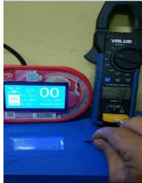
Gambar 5.1. Pengukuran temperatur menggunakan monitor LCD dan multimeter.
