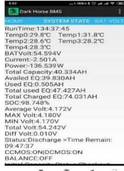
Gambar 5.3. Tampilan hasil monitoring pada proses pengosongan baterai Li-Po pada kondisi SOC 98.748%.
