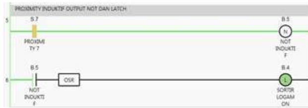
Gambar 10. Sensor Proximity Induktif Deteksi Logam
