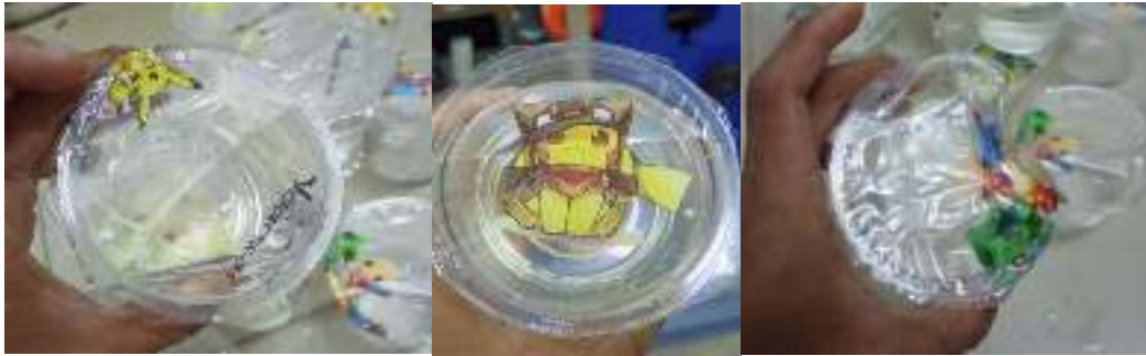
Gambar 6. Pengujian pengepresan pada suhu dibawah 180 0 C, 180-190 0 C, dan diatas 190 0 C
